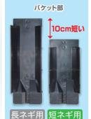
新型バケットの採用で 短ネギの根葉切り作業が可能に!
