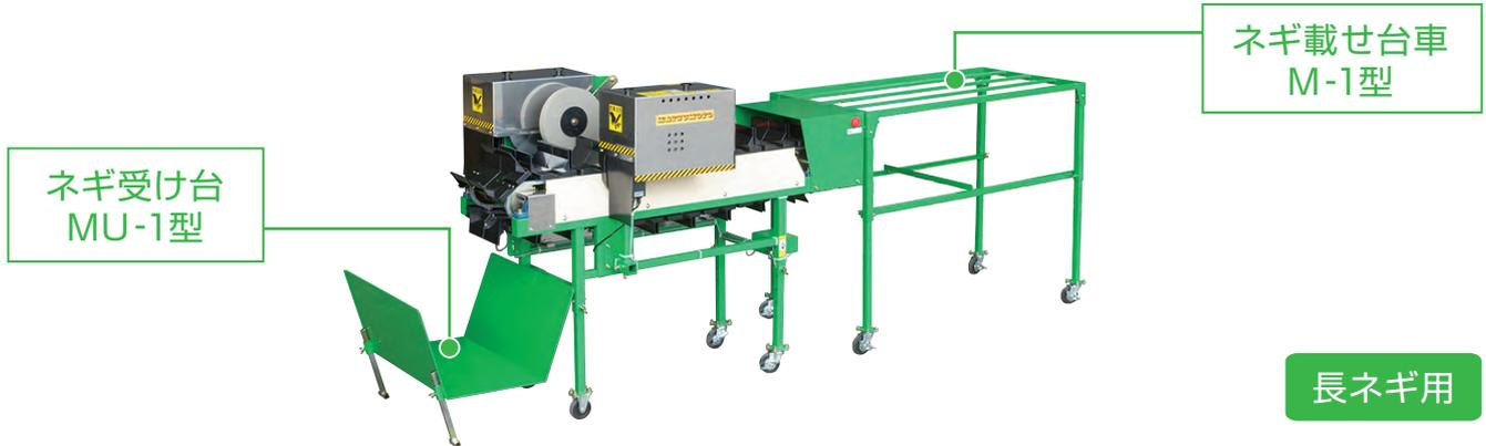
1台の根葉切り機で、複数台の皮むき機に対応
